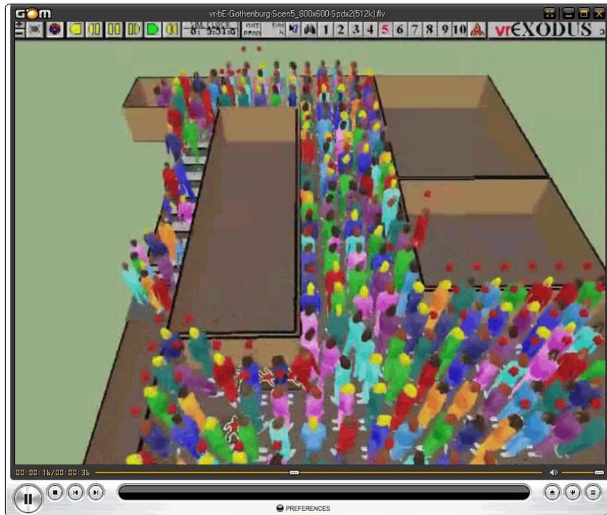
Figura 2 – Simulación de evacuación de edificio incendiándose con el programa buildingEXODUS 3.0
